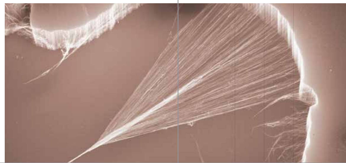
Carbon-Nanoröhrchen bilden einen Faden.
