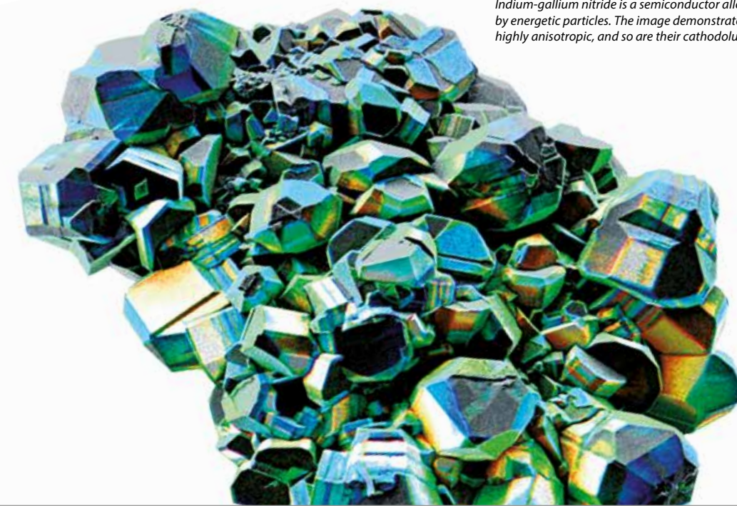
Indium-Gallium-Nitrid ist eine Halbleiterlegierung, die bei Bestrahlung mit energetischen Partikeln Licht emittiert. Das Bild zeigt, dass InGaN/GaN-Strukturen stark anisotrop sind, ebenso wie ihre Kathodolumineszenzeigenschaften.
